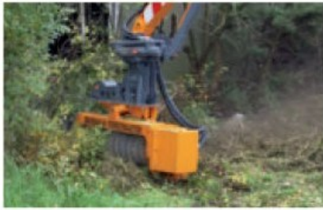
Hydraulisch angetriebenes Modell zum Anbau von Mähbalken oder Kranauslegern.
