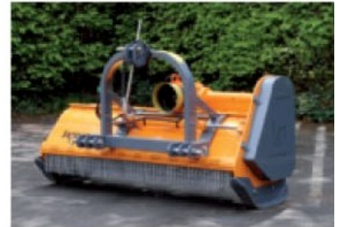
Zylinder für seitlichen Versatz per Hydraulik (Option).
