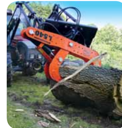
Woodcracker® L beim Aufspalten von dicken Stämmen.
