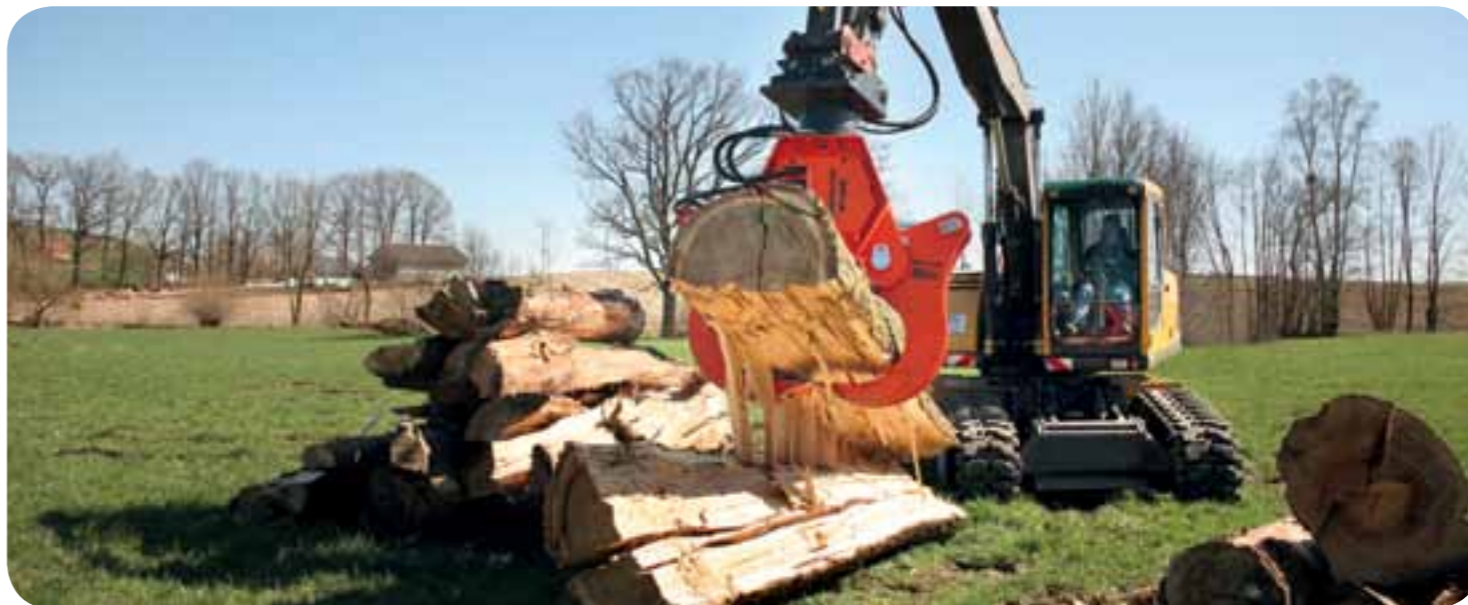
Woodcracker® W beim Aufspalten von dicken Stämmen.
