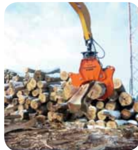
Woodcracker® W beim Aufspalten von dicken Stämmen.
