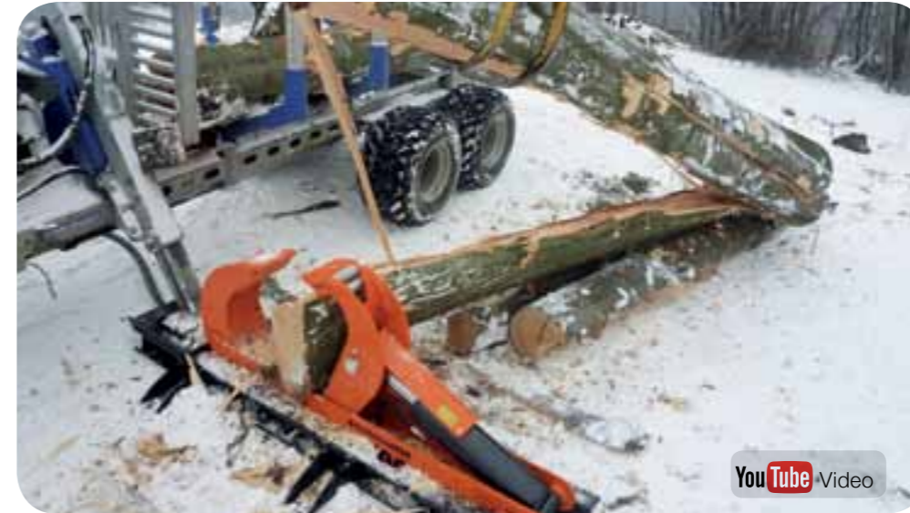
Woodcracker® L beim Aufspalten von dicken Stämmen.
