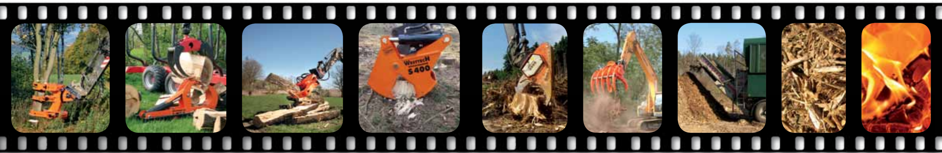
Woodcracker® C, CB und CS ernten Bäume und Sträucher mit bis zu 75 cm Stammdurchmesser.
