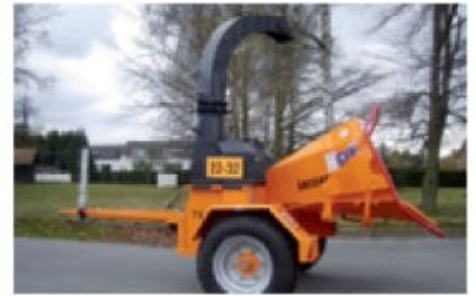
Fahrgestell für den langsamen Transport mit 40 km/h ausgelegt
