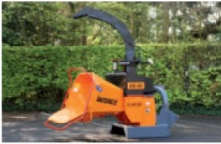
TV22-32 P; mit Schlepperantrieb.
