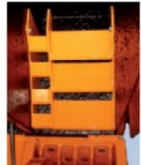
TV22-32 P; System zur Nachzerkleinerung (Option).
