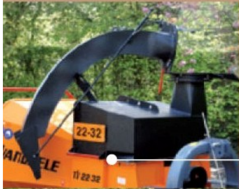
Nach unten klappbares Auswurfrohr (Option)
