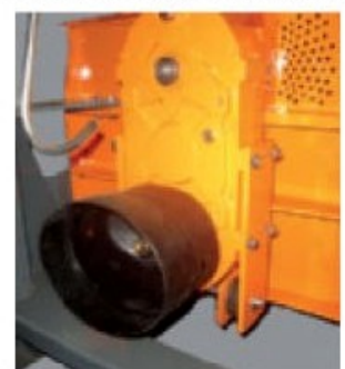
TV22-32 P; Getriebe mit 540 U/min (Option)
