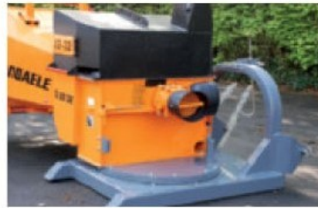
TV22-32 P; mit Schlepperantrieb, um 2 x 90° schwenkbar (Option).
