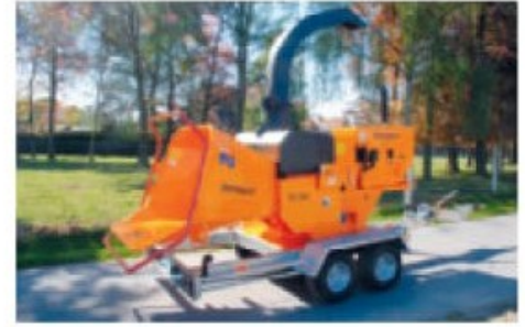
Maschine mit Motorantrieb auf Fahrgestell für Schnelltransport
