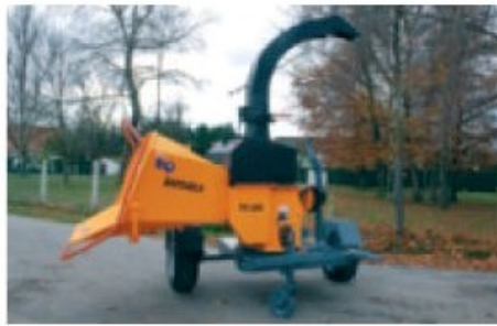
TV250 P; mit Schlepperantrieb auf schwenkbarem Fahrgestell für den langsamen Transport (Option).
