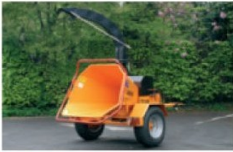
TV250 P; mit Schlepperantrieb auf Fahrgestell für den langsamen Transport (Option).
