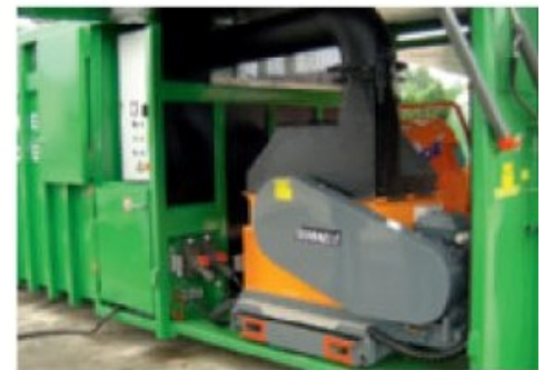
TV250 P; Sonderanfertigung nach Kundenwunsch – Antrieb über Elektromotor; in einen Container eingebaut.
