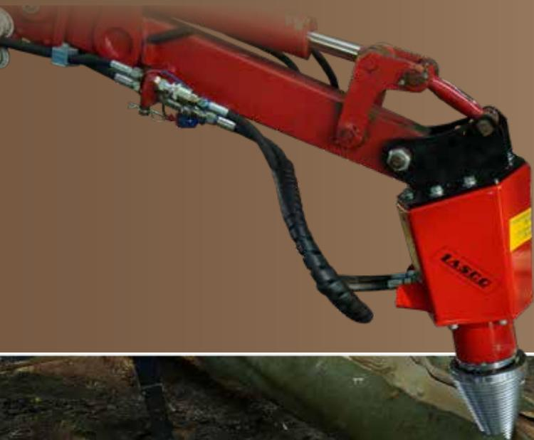
Der Gewindekegel schraubt sich in den Baumstamm und sprengt diesen auf.
