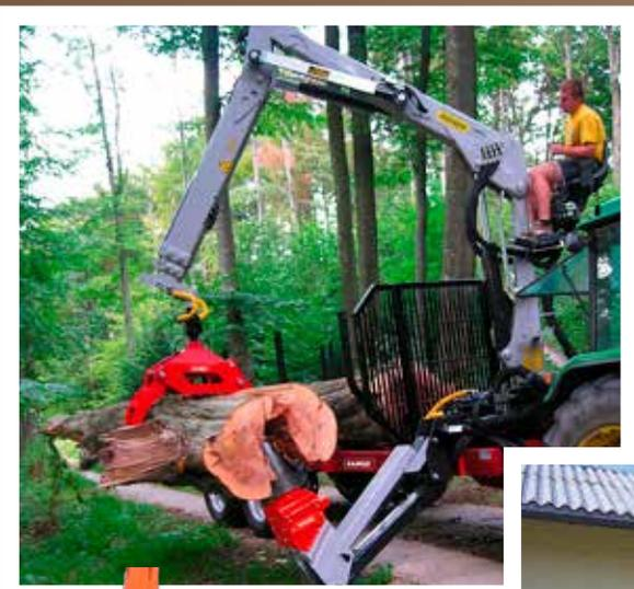
Aufgrund der großen Produktpalette, lässt sich der LASCO Kegelspalter auf beinahe jedes Trägerfahrzeug mit Hydraulik erfolgreich einsetzen.
