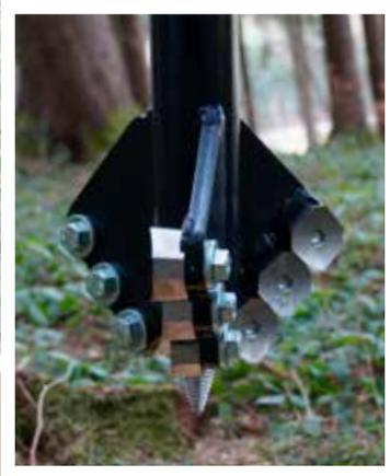
Die LASCO Stockfräse wurde zum Aufspalten von Wurzeln entwickelt, um so das Erdreich im Wald wieder für die Neubepflanzung vorzubereiten. Insgesamt neun gehärtete Messer finden auf dem Anbaugerät Platz.
