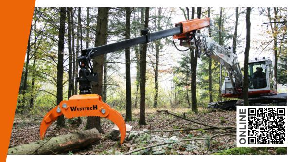
Die Telestufe für den Bagger zur Erhöhung der Reichweite ohne Umbauarbeiten.
