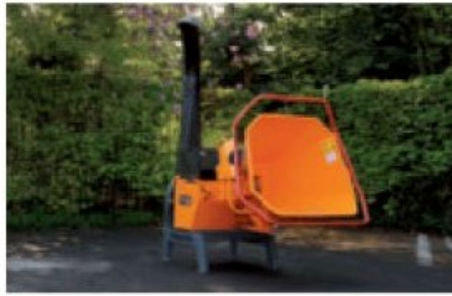
Maschine mit 3-Punkt-Anhängung, standardmäßig über Schlepper angetrieben
