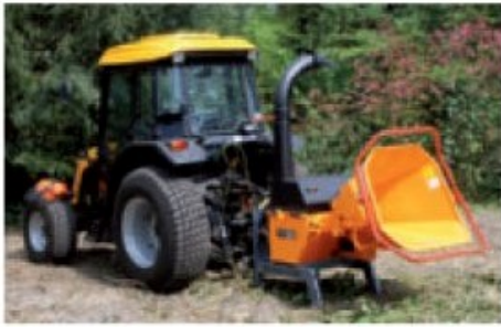
TVI 20 P; kann schon mit geringer Schlepperleistung angetrieben werden (20 PS)
