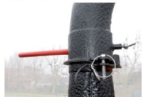
Um 300° schwenkbares Auswurfrohr (Sicherheit) mit Transportstellung.
