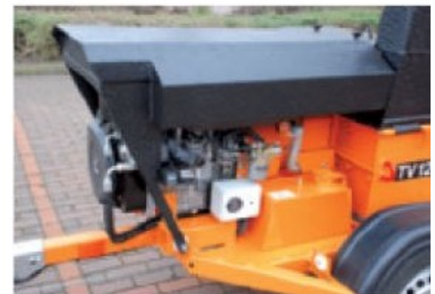
TVI 20 D; luftgekühlter Lombardini-Dieselmotor; 2 Zylinder, 21 kW – 28,5 PS.
