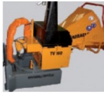
Ausführung mit Hydraulikantrieb für Geräteträger
