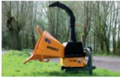
Maschine mit 3-Punkt-Anhängung, standardmäßig über Schlepper angetrieben
