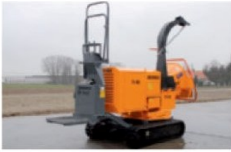
Hydraulisch angetrieben auf Raupen-Fahrgestell
