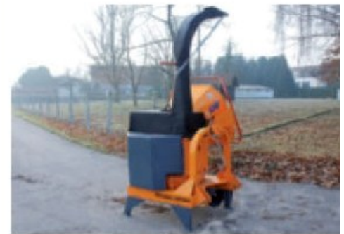
TVI 160 PT; optionale Ausführung mit Dreipunktaufhängung und um 270° schwenkbar
