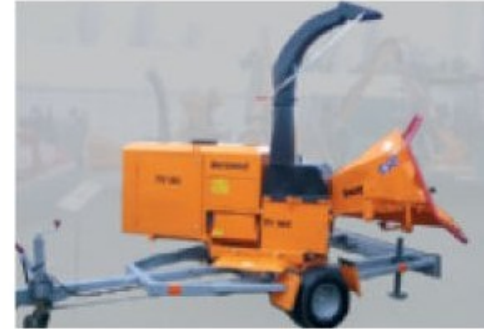
TVI 160 D; auf Fahrgestell für den Schnelltransport montierte Option, um 360° schwenkbar
